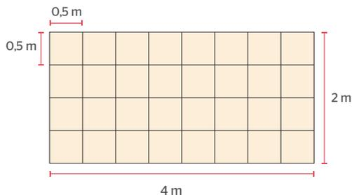
Tomando en cuenta la altura del camión (2 m) y las cajas medianas (0,5 m), se tienen 4 niveles. En cada nivel, entran 32 cajas medianas. Por lo tanto, como máximo, pueden entrar 128 cajas medianas en el compartimento.
